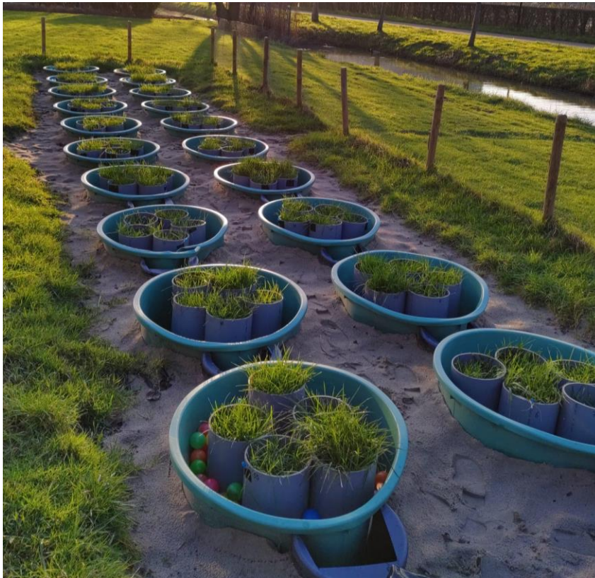
Foto: De proefopstelling met in iedere tank vijf veenkolommen. De tanks zijn ingegraven om zo grote temperatuurfluctuaties in de kolommen te voorkomen. Alle tanks hebben een opening op de gewenste waterstand zodat overtollig water na een regenbui kan wegllopen.
