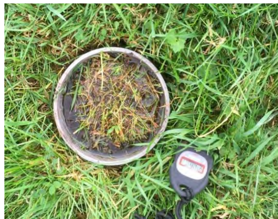
Figuur 4.3 a) met de zogenaamde koeienpootmethode wordt de insporing van de grond gesimuleerd die op zou treden bij betreding (Janssen et al., 2023); b) waterinfiltratiemeting.
