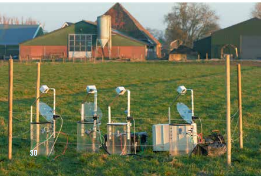
Gasmetingen in het grasland met drukdrainage
