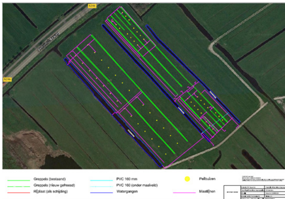
Figuur 3: Overzicht greppel infiltratie
