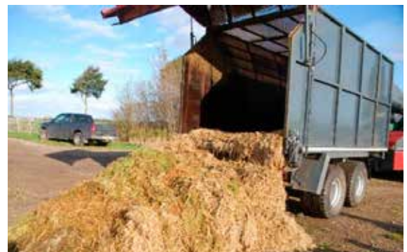
Figuur 5-25.: Beeld van het oogsten van lisdodde middels een maai-zuigcombinatie. De oogst is schoon en de planten zijn onbeschadigd, niet geknakt.
