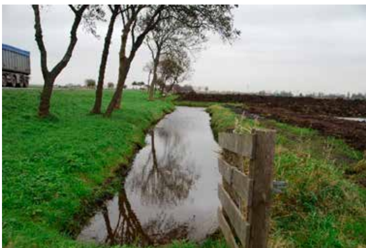
Figuur 3.2.: Sloot langs de provinciale weg met het bestaande polderpeil. Rechts één van drie automatische inlaten als inlaat van een regelsloot.
