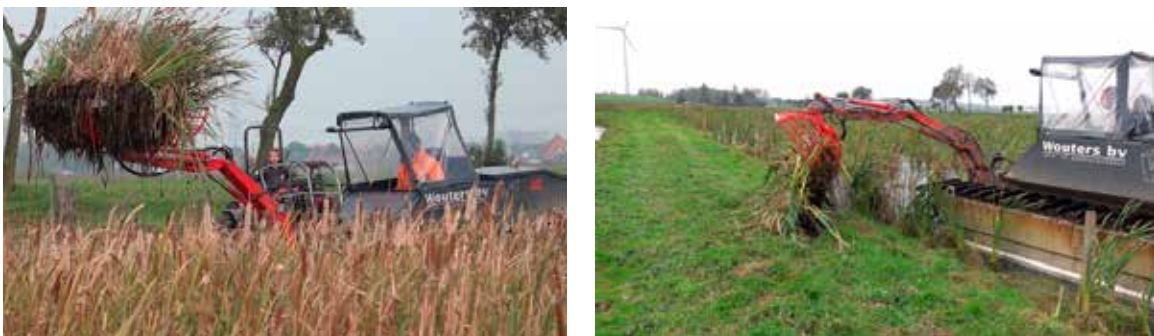
Figuur 5-24. :De Truxor oogst is varend door het vak, de gehele planten (foto links) worden naar de kade gebracht. Bij de oogst worden ook wortels en slib meegenomen.
