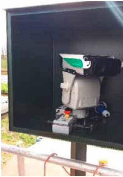
Figuur 5-21.: Geplaatste laser op paal in ijzeren omlijsting.
