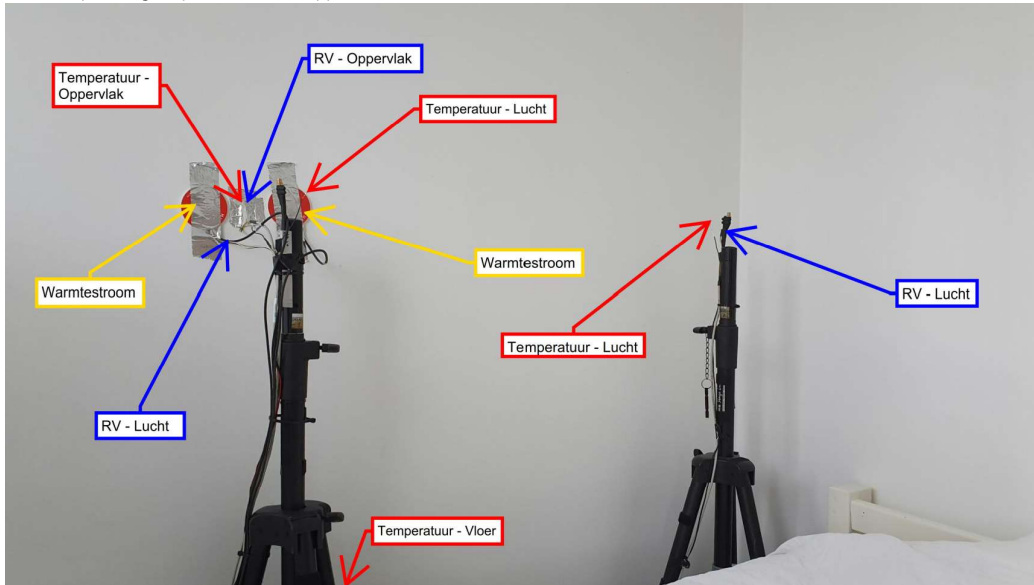
f2.3 Meetopstelling ter plaatse van de appartementen
