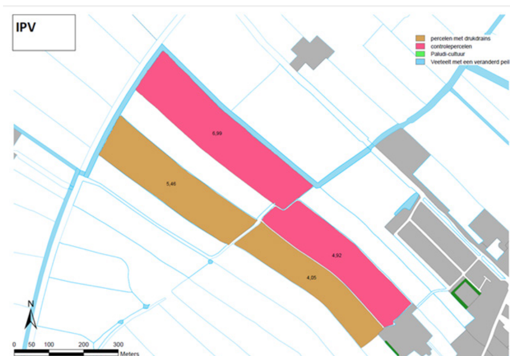
Figuur 3.4: Plattegrond proefpercelen met en zonder drukdrains op het pilot melkveebedrijf van het IPV in Assendelft.
