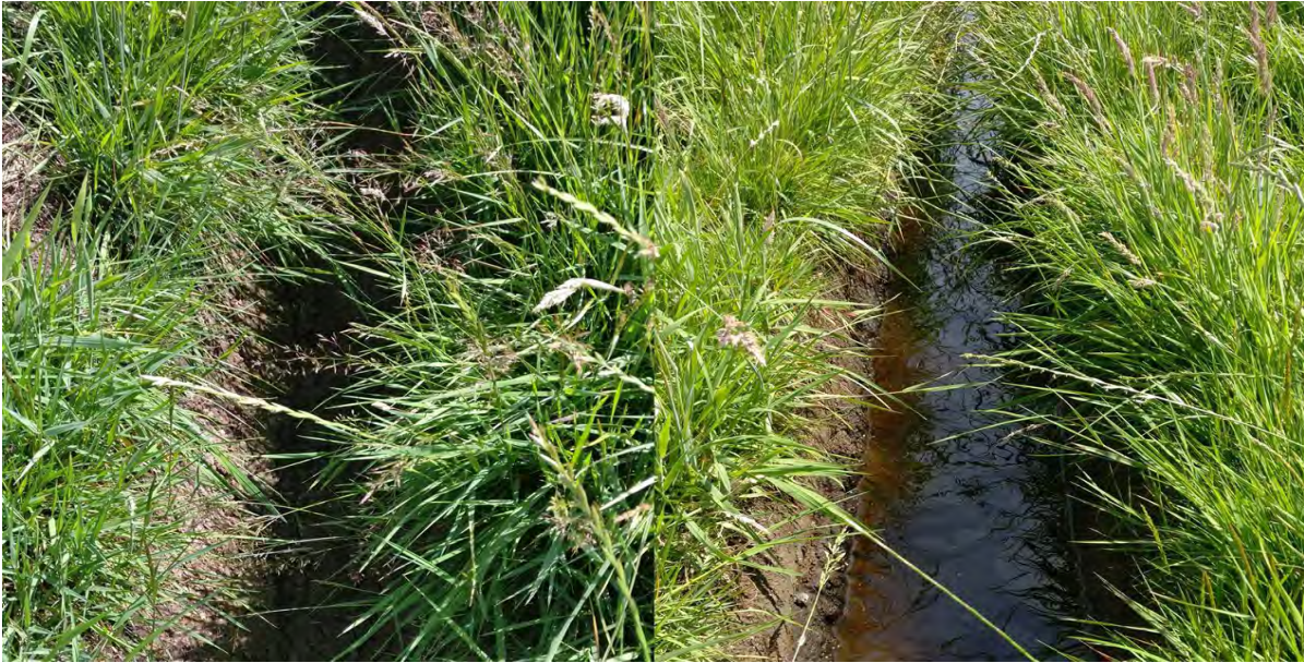
Figuur 2.6: Voor het praktijkexperiment met greppelinfiltratie zijn op verschillende percelen greppels aangebracht op 6m, 12m en 24 m afstand van elkaar. Per perceel is gewerkt met een 'interne referentie', wat wil zeggen dat de greppels daar niet-watervoerend zijn gemaakt (links). Foto's: Bas van de Riet.
