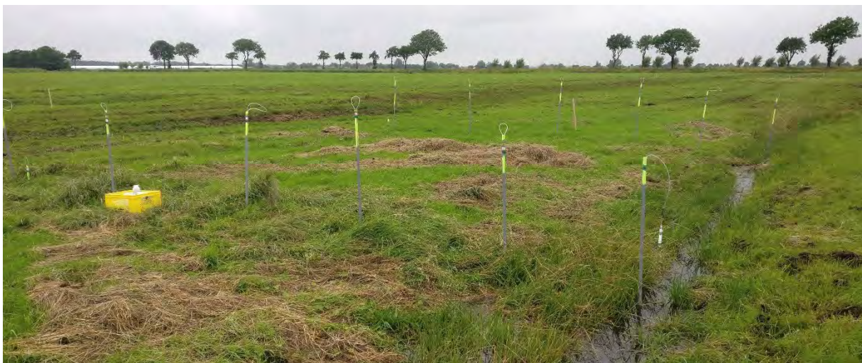
Figuur 3.22: Poriewaterbemonstering in het perceel met greppelinfiltratie. Links de permanent watervoerende greppel. De keramische cups zijn in een gradient geplaatst vanaf de greppel (0 m) tot aan het midden van het perceel (6 m). Foto: Bas van de Riet, 9 juli 2020.
