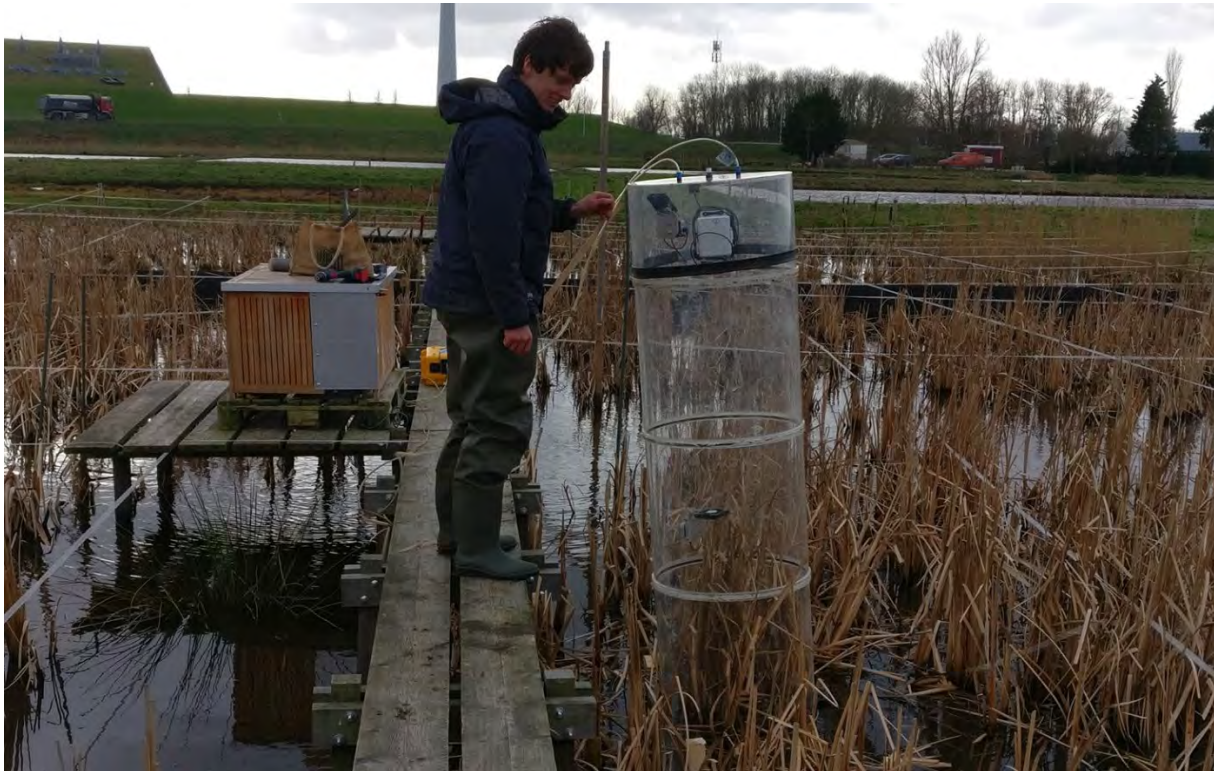
Figuur 2.11: Handmatige kamermetingen in de graslanden in Assendelft (boven) en in grote lisdodde in het Zuiderveen West. De lichtmetingen zijn uitgevoerd onder verschillende condities ten behoeve van de berekening van de jaarbalans. Voor de metingen aan lisdodde zijn modulaire kamers gebruikt die verhoogd konden worden naarmate de vegetatie hoger werd. Foto's: Thomas Gremmen en Bas van de Riet.
