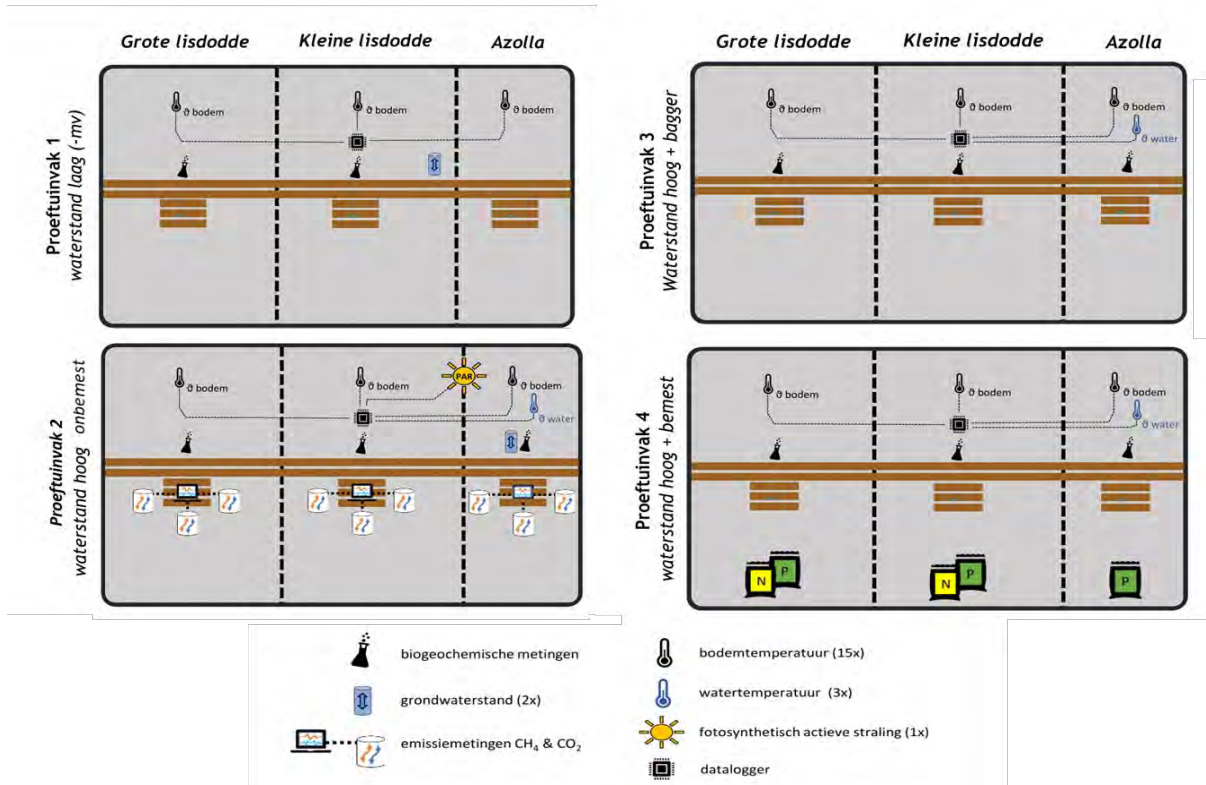
Figuur 2.13: Schematische weergave van de proeftuinvakken in het Zuiderveen (elk ca. 8 x 30 m) met daarin subvakken waarin grote lisdodde, kleine lisdodde en azolla werden geteeld. In de proeftuinvakken kon gevarieerd worden met waterstand en werden nutriënten toegevoegd door inbreng van bagger (PT3) of bemesting (PT4). Diverse sensoren werden geplaatst waarmee fotosynthetisch actieve straling, water- en bodemtemperatuur en waterstanden continu werden geregistreerd. In alle proeftuinvakken werden veranderingen in (porie)waterchemie gemonitord. De broeikasgasmetingen ten behoeve van de jaarbalansberekeningen werden uitgevoerd in proeftuinvak 2 (in 2019 in proeftuinvak 4 toen deze nog niet bemest was).
