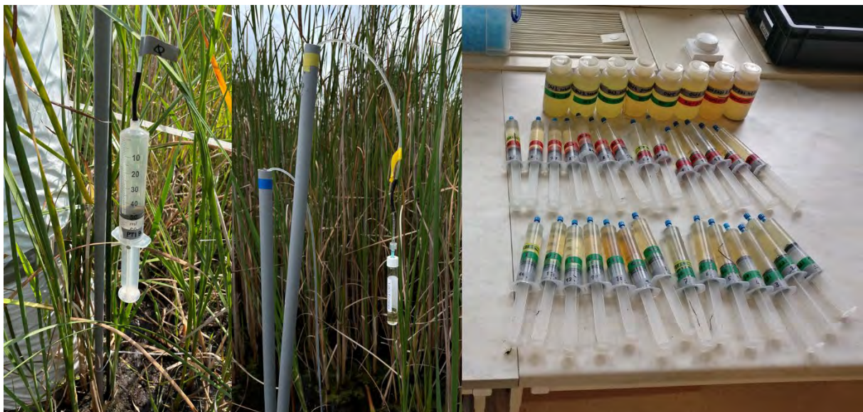
Figuur 2.18: Bemonstering ten behoeve van de biogeochemische monitoring in het Zuiderveen. Met een keramische cup wordt poriewater verzameld naast de locatie waar broeikasgassen worden gemeten (links); met dezelfde keramische cups wordt in een glazen exetainers bodemvocht verzameld om de hoeveelheid opgelost methaan en sulfide te meten (midden); de oppervlakte- en poriewatermonsters worden geanalyseerd en de volgende dag geanalyseerd in het laboratorium (rechts). Foto's: Bas van de Riet.
