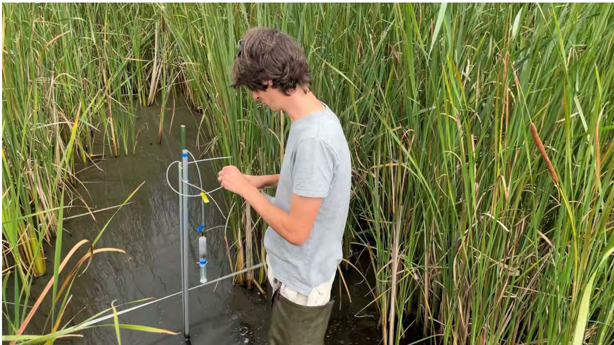
Figuur 2.16: Bemonstering met keramische cup in de wortelzone van kleine lisdodde. Het poriewater wordt verzameld door een vacuüm spuit aan de cup te hangen.
