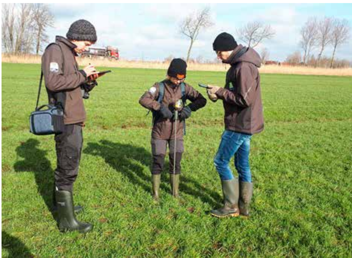
Afbeelding 3: Het meten van de indringingsweerstand met een penetrometer
