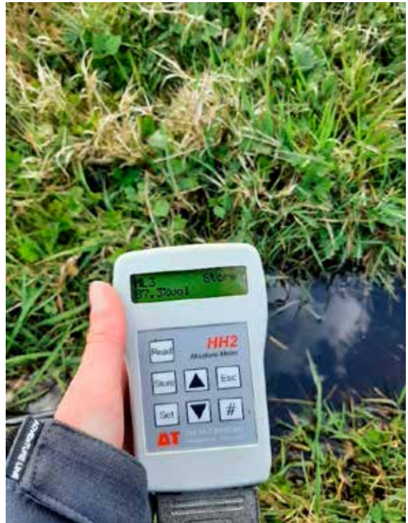
Afbeelding 5: Het meten van het vochtgehalte van de bodem met een HH2 moisture meter en de ML3 Thetaprobe sensor.
