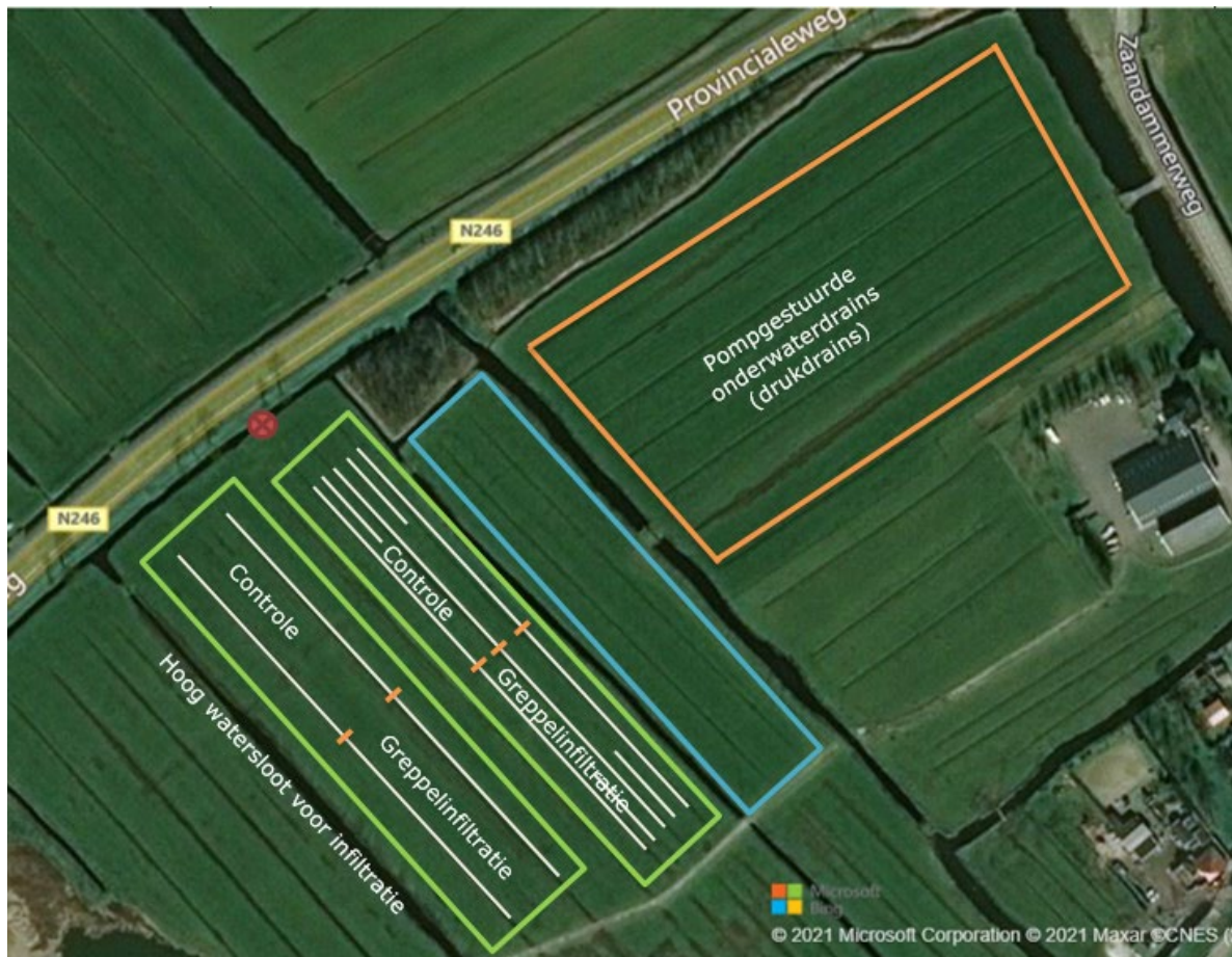
Figuur 3.5 Plattegrond proefpercelen greppelinfiltratie (groen kader) met een greppelafstand van 6, 12,5 en 20 m (wit lijnen), controle perceel (blauw kader) en pompgestuurde onderwaterdrains (oranje kader). Het rode rondje met kruis geeft de positie van de eventueel te plaatsen plas-dras pomp weer.
