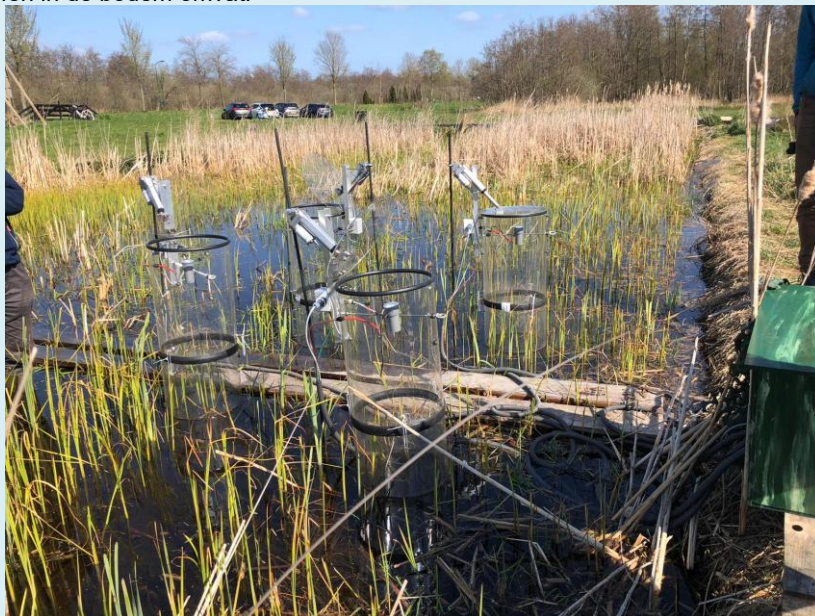
Figuur 10. Voorbeeld van de metingen aan broeikasgasemissies met behulp van automatische kamers (24 april 2021).
