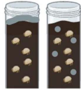
Figuur 14 In een laboratorium experiment is getest of springstaarten kleideeltjes door de veenbodem mengen.
