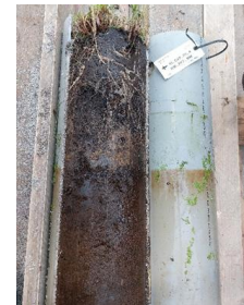
Figuur 15 Bij de bemonstering van de kolommenproef werden de kolommen opengezaagd. De bewortelingsdiepte en het waterniveau zijn duidelijk te zien
