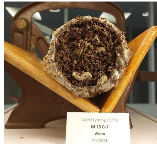
Figuur 13 In de toplaag van de kolom met de behandeling waarbij wormen werden toegevoegd zijn nog maar een paar stukjes van de lichte klei te zien.
