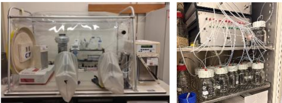
Figuur 15 CO 2 -emissie uit grondmonsters wordt in het lab van de Universiteit Utrecht gemeten. Monsters van onder het waterpeil worden in een anoxische kamer verwerkt om onder zuurstofvrije omstandigheden CO 2 -emissie te kunnen meten
