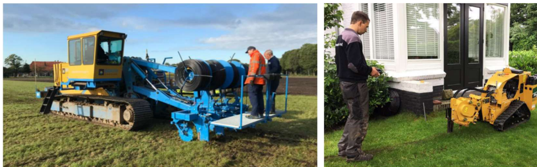
Figuur 11. Slangen gelegd met een grotere machine zoals toegepast in de akkerbouw. Rechts een machine zoals toegepast voor sportvelden.
