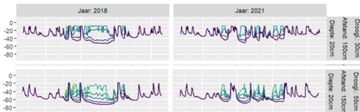
Figuur 6. Impressie van modelresultaat die laat zien dat het verhogen en op niveau houden van de grondwaterstand ook in een extreem droog jaar als 2018 goed mogelijk is.
