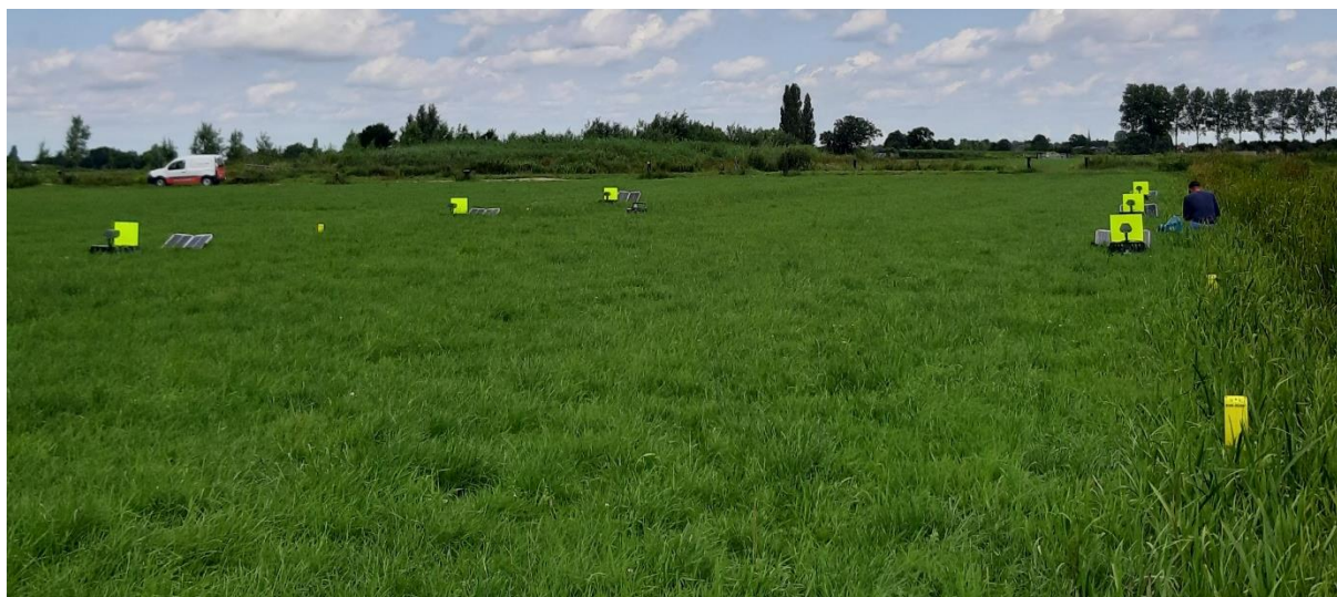
Figuur 7: Diopsis insectencamera's, pot- en plakvallen in een hoogwatermaai perceel voor het meten van resp. vliegende, lopende en nog eens vliegende insecten, zowel langs de slootkant (rechts) als midden (links) op het perceel (juli 2022).
