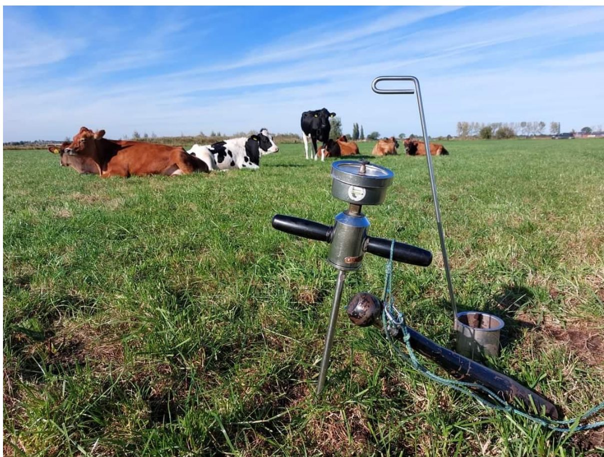
Figuur 5: Draagkrachtmetingen met penetrometer en de koeienpootmethode. De koeienpootmethode bleek geen aanvullende informatie op te leveren, dus wordt per 2023 niet meer ingezet.
