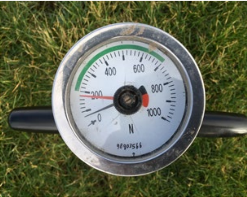
■ Penetrometer Draagkrachtmetingen worden verricht met een penetrometer en uitgedrukt als de hoeveelheid kracht die nodig is om een conus van 5 vierkante centimeter door de zode heen te drukken. Foto: Louis Bolk Instituut
